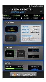
El **LUZ PRUEBA** se utiliza para comprobar la iluminación del vehículo sometido a prueba: brillo, tiempo de espera, comportamiento en caso de salida de pista.
