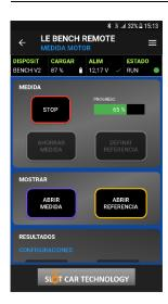
Para empezar a medir un motor, pulse el botón **START**. La medición se detiene automáticamente después de ejercitar el motor en incrementos de revoluciones del 5%.
