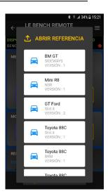
Para comparar una medición realizada con una medición previamente registrada, pulse el botón **ABRIR REFERENCIA** y elija la medición.
