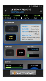
La prueba **SIMU DRIVE** verifica el comportamiento dinámico del vehículo simulando la conducción en la pista y realizando una sucesión de vueltas.
