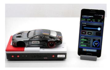
Alimenta el motor eléctrico del automóvil que se está probando y mide el voltaje suministrado, así como la corriente y la potencia absorbidas. El Bench V2 también mide la velocidad de rotación del motor, sin sensor, gracias a un algoritmo patentado que ofrece una precisión del 0,1% del valor medido en el intervalo de 3.000 a 50.000 RPM (rotaciones por minuto).
