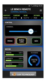
En la sección **CONTROL**, el control deslizante le permite ajustar el punto de ajuste del motor manualmente. El botón **FREINO** detiene el motor con el frenado máximo, el botón **RUEDA LIBRE** detiene la inercia del motor. El botón **MAX** establece el punto de consigna del motor al 100%.
