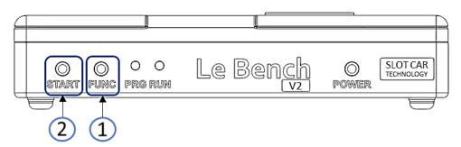
Los LED PRG y RUN parpadean 3 veces y luego se apagan, indicando la parada del Bench V2.
