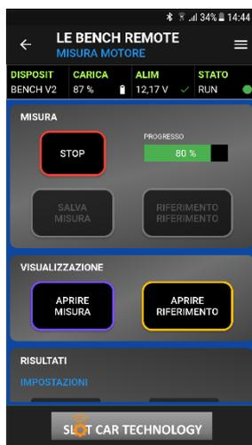
Per iniziare a misurare un motore, premere il pulsante **START**. La misurazione si interrompe automaticamente dopo aver esercitato il motore con incrementi del 5% di giri/min.
