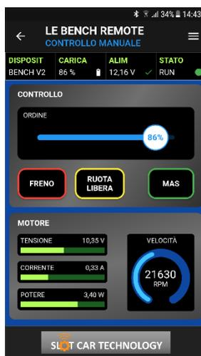
Nella sezione **CONTROLLO**, il cursore consente di regolare manualmente il setpoint del motore. Il pulsante **FRENO** arresta il motore con la massima frenata, il pulsante **RUOTA LIBERA** arresta il motore per inerzia. Il pulsante **MAS** imposta il setpoint del motore al 100%.
