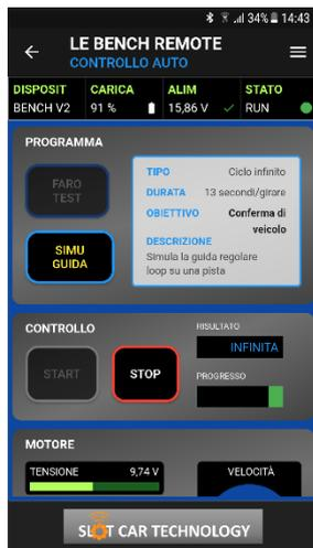
Il test **SIMU DRIVE** verifica il comportamento dinamico del veicolo simulando la guida in pista ed eseguendo una successione di giri.
