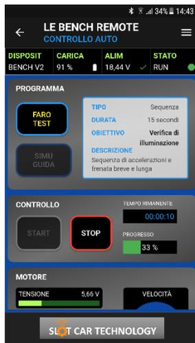
Il **LIGHT TEST** serve a verificare l'illuminazione del veicolo in prova: luminosità, tempo di attesa, comportamento in caso di partenza dalla pista.
