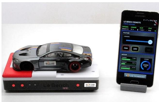
Alimenta il motore elettrico dell'auto in prova e misura la tensione fornita, nonché la corrente e la potenza assorbita. **Il Bench V2 misura anche la velocità di rotazione del motore**, senza sensore, grazie ad un algoritmo proprietario che offre una precisione dello 0,5% del valore misurato nell'intervallo **da 3.000 a 50.000 RPM (rotazioni al minuto)**.
