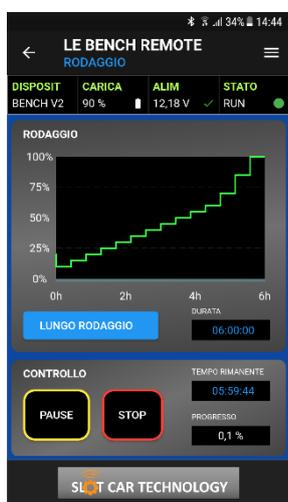
Il **LUNGO RODAGGIO** esercita il motore dal 10% al 100% impostato in 14 passi per un periodo di 6 ore.
