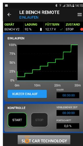
Die **SHORT RODAGE** betätigt den Motor in 8 Stufen über einen Zeitraum von 30 Minuten von 10% auf 100%.
