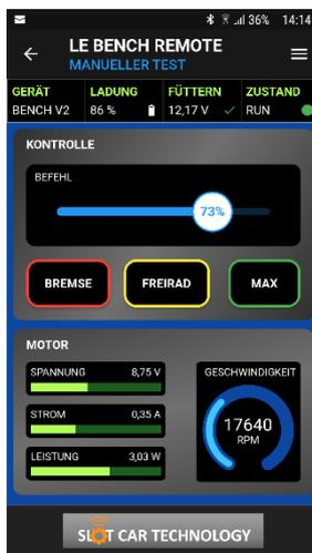
Im Bereich **CONTROL** können Sie mit dem Schieberegler den Sollwert des Motors manuell einstellen. Die **BREMSE-Taste** stoppt den Motor bei maximaler Bremsung, die **FREIRAD-Taste** stoppt das Ausrollen des Motors. Die **MAX-Taste** stellt den Motorsollwert auf 100 % ein.
