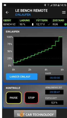
Der **LONG ROD** trainiert den Motor von 10% auf 100% eingestellt in 14 Stufen über einen Zeitraum von 6 Stunden.
