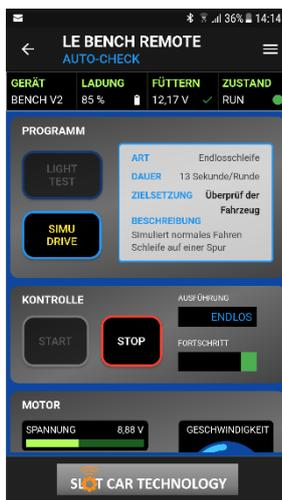
Der **SIMU DRIVE-Test** verifiziert das dynamische Verhalten des Fahrzeugs, indem er das Fahren auf der Rennstrecke simuliert und eine Reihe von Runden absolviert.
