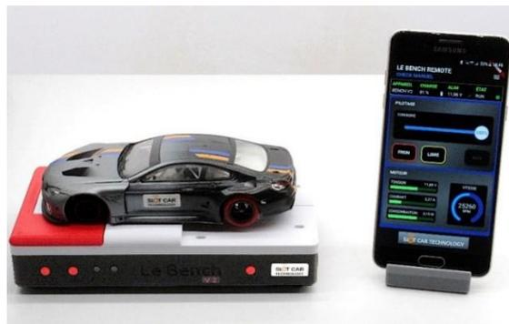
Er versorgt den Elektromotor des zu prüfenden Fahrzeugs mit Strom und misst die gelieferte Spannung sowie den aufgenommenen Strom und die aufgenommene Leistung. **Der Bench V2 misst auch die Drehzahl des Motors** ohne Sensor dank eines proprietären Algorithmus, der eine Genauigkeit von 0,1 % des Messwerts über das Intervall von 3.000 bis 50.000 U/min (Umdrehungen pro Minute) bietet.
