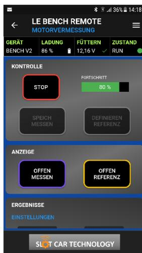
Um mit der Messung eines Motors zu beginnen, drücken Sie die **START-Taste**. Die Messung stoppt automatisch nach dem Trainieren des Motors in Schritten von 5 % Drehzahlsteigerung.
