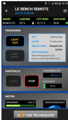
Der **LIGHT TEST** dient dazu, die Beleuchtung des zu testenden Fahrzeugs zu überprüfen: Helligkeit, Haltezeit, Verhalten bei Landebahnabfahrt.
